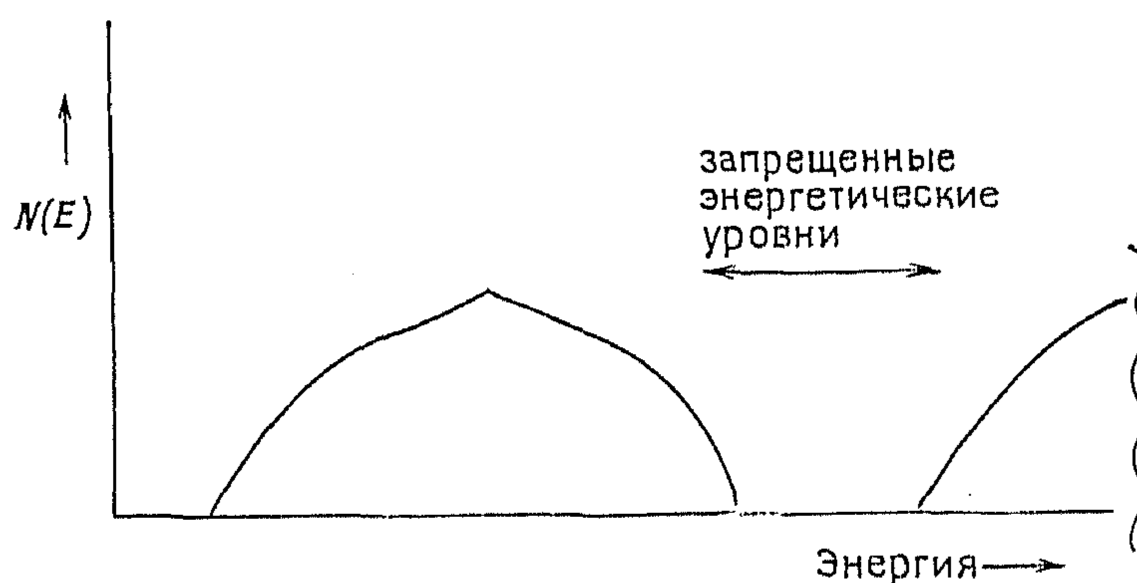
Рис. 14.7. Плотность состояний согласно зонной теории.
