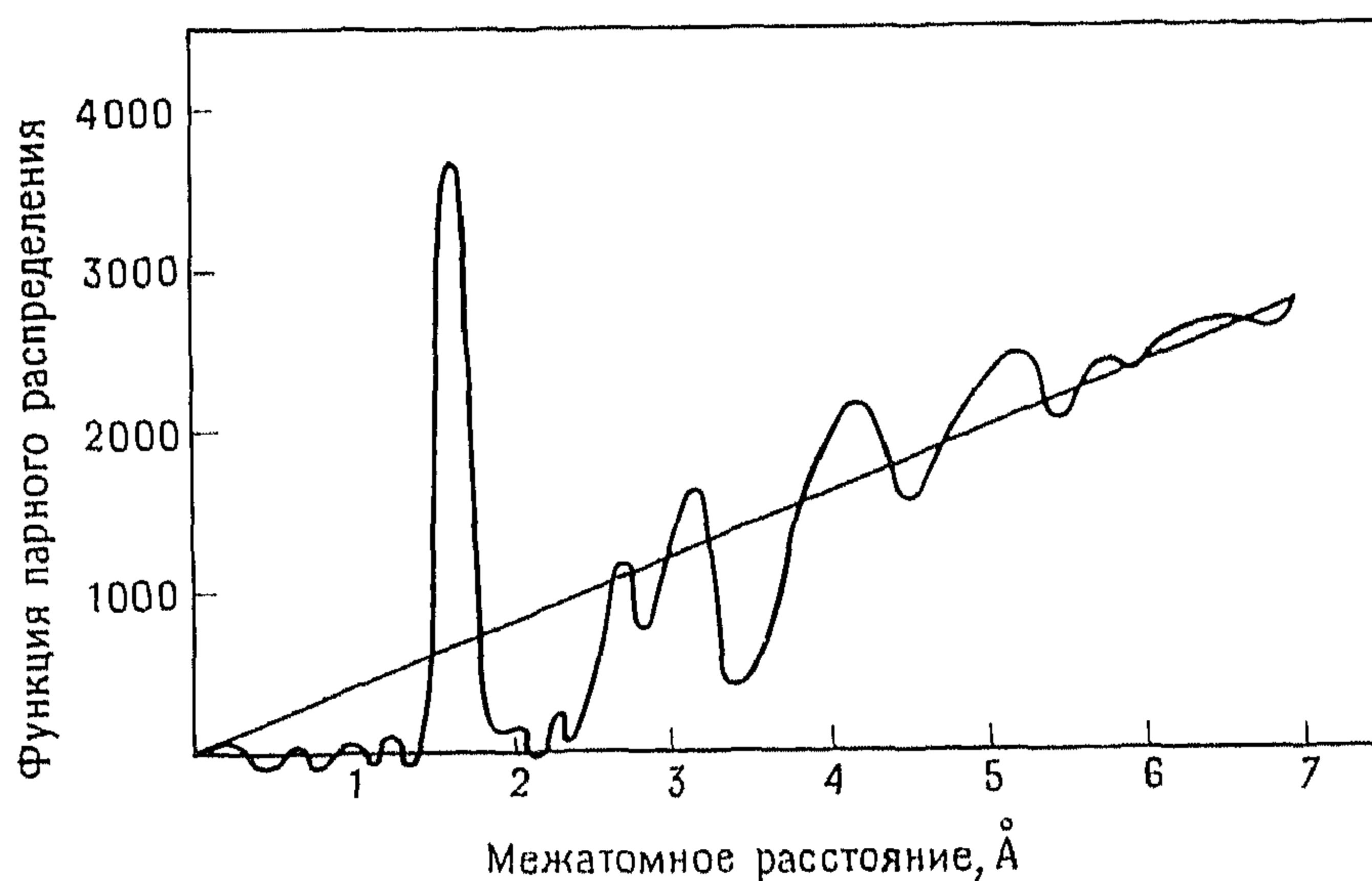
Рис. 18.7. Результаты рентгеновского исследования кварцевого стекла [11].
