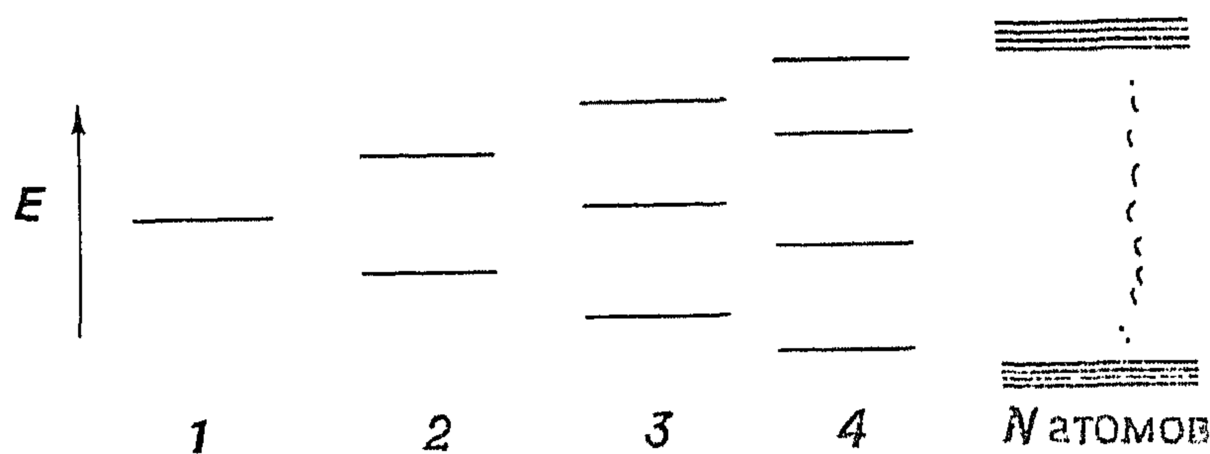
Рис. 14.2. Расщепление энергетических уровней согласно теории молекулярных орбиталей.
